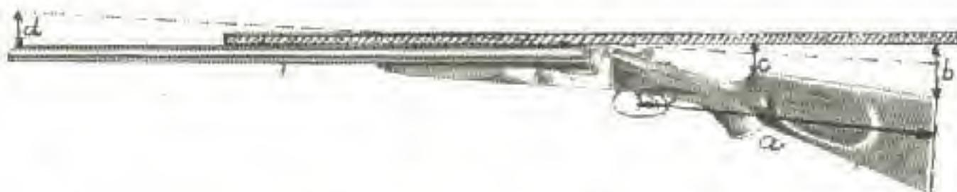
Tačne dimenzije kundaka, vidljive na slici, mogu se izmjeriti tako što se na šinu postavi duži linijar ili ravna letva koji dostižu preko cijelog kundaka a zatim se lako određe pad u nosu i peti, dimenzije c i b, dužinu kundaka - a - mjerimo od prvog obarača do sredine kape, a izvijenost odredimo tako da pušku postavimo normalno na sto i viskom koji stoji u pravcu produžetka nišanske linije preko kape kundaka odredimo e i f. Sve izmjerene vrijednosti zapišemo.
